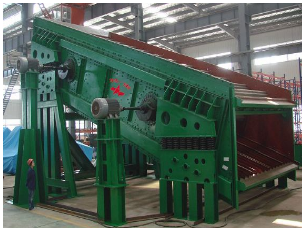
图 5 筛分面积为 56m 2 的激振力不同的反向回转双激振器自同步式巨型振动筛
