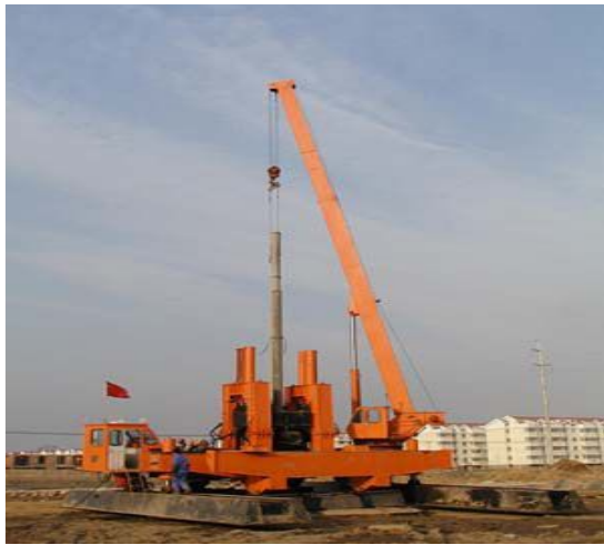
图 10 750 吨液压驱动振动桩机
